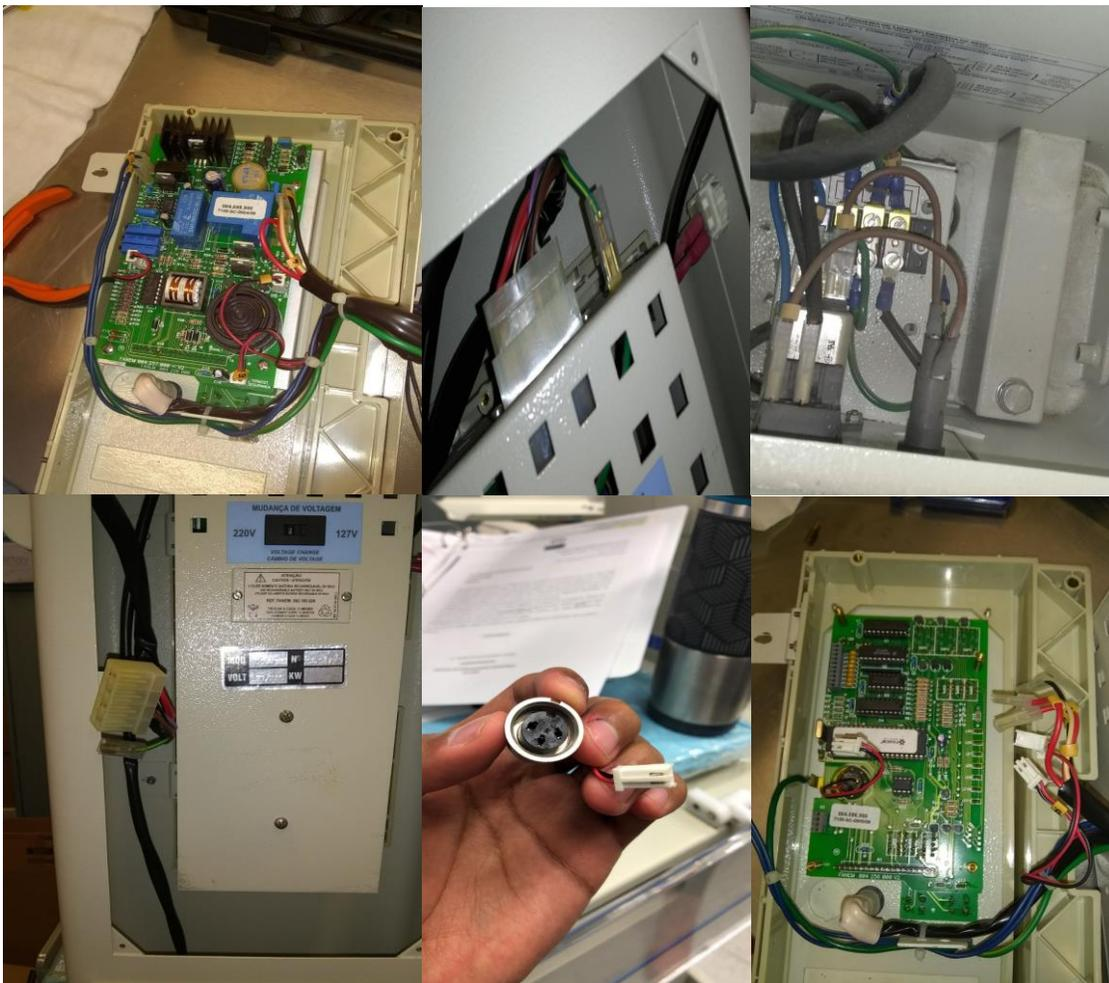
*Ilustración 5. Mantenimiento correctivo del conector de una cuna térmica.*
