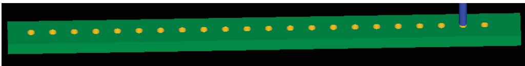
Figura 3.24: Perforación de los barrenos
