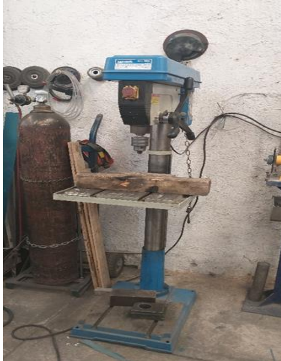
Ilustración 7. taladro este nos sirve para hacer agujeros o cortes en cualquier material
