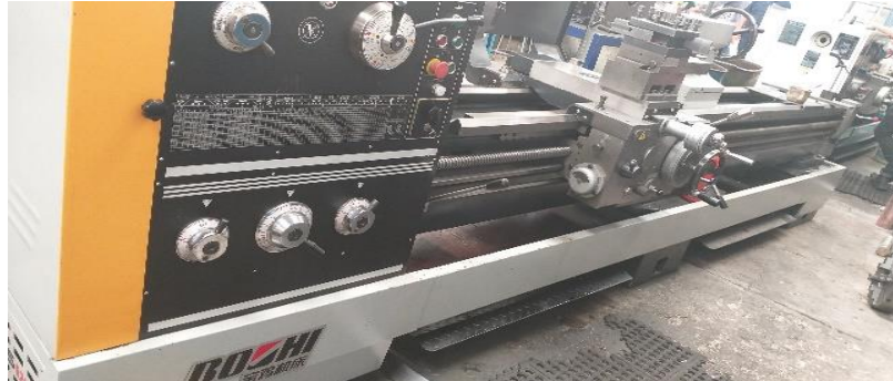
Ilustración 1. Torno es una herramienta industrial que permiten mecanizar piezas de forma geométrica de revolución
