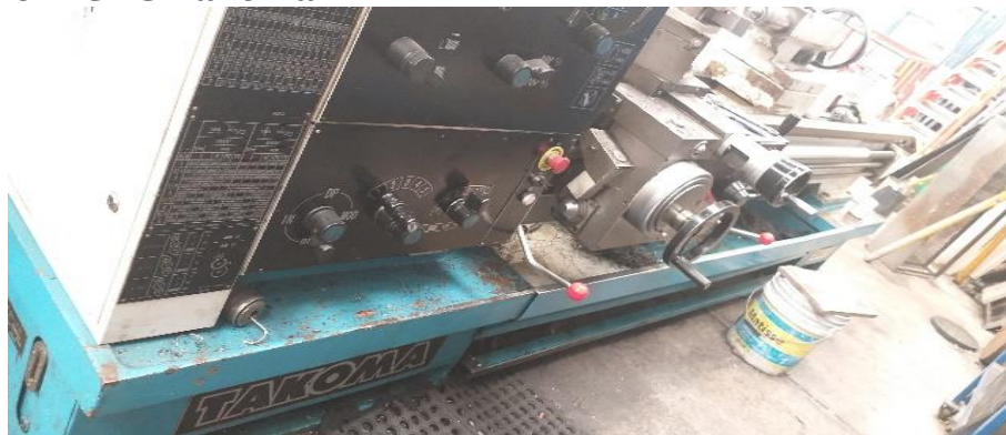
Ilustración 2. Torno permiten mecanizar piezas de forma geométrica de revolución
